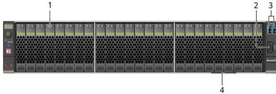
图 5-2 25x2.5 英寸硬盘配置前面板组件
