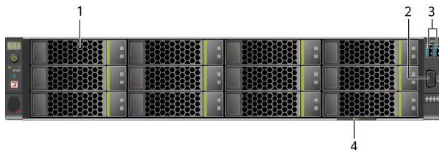
图 5-1 12x3.5 英寸硬盘配置前面板组件
