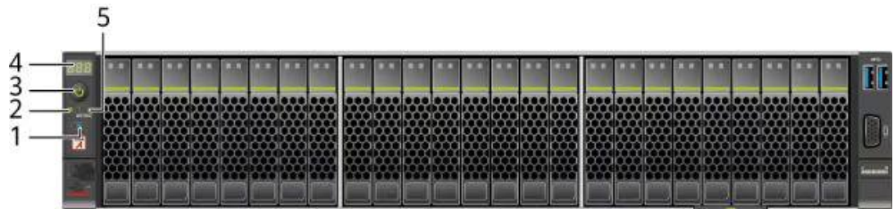
图 5-8 25x2.5 英寸硬盘配置前面板指示灯和按钮
